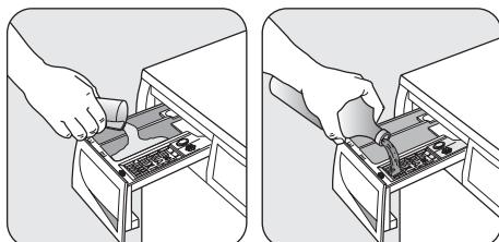
Вытяните до упора дозатор моющих средств. Отмерьте необходимое коли- чество моющего средства, поместите его в отделение дозатора, предна- значенное для основной стирки или в со- ответствующее отделение, если этого требует выбранная программа/дополнительная функция (более подробную информацию см. в разделе "Дозатор моющих средств").
