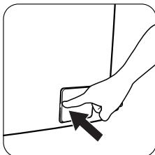
Закройте дверцу фильтра сливного насоса.
