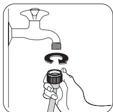
Присоедините наливной шланг к водопроводному крану с резьбой 3/4". Всегда используйте шланг, поставляемый вместе со стиральной машиной.
