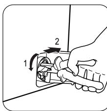
Когда вода перестанет литься, открутите крышку фильтра и с помощью плоскогубцев извлеките фильтр. Всегда держите под рукой тряпку, чтобы вытереть воду, которая может пролиться при снятии фильтра.
